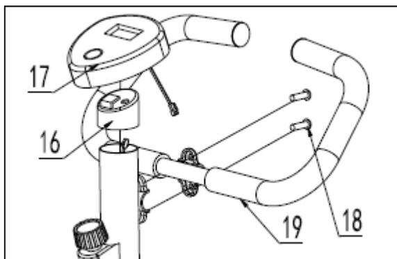
Fije el soporte de la computadora. Fije el volante y ajuste a la posición deseada.
