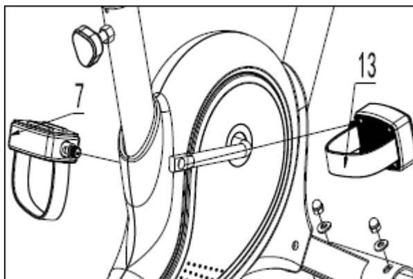
Atornille ambos pedales. Preste atención a las marcas de los pedales L - rosca izquierda, R - rosca derecha.
