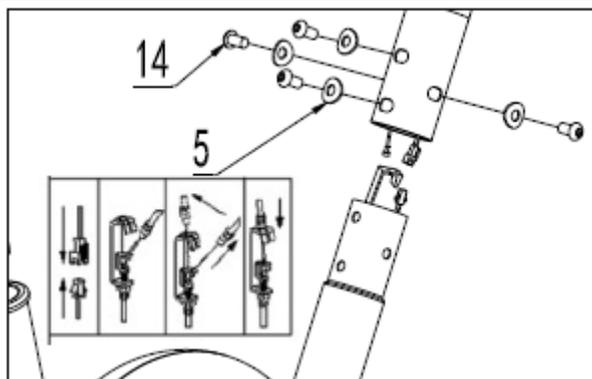
Conecte los cables. Fije la columna de dirección al marco principal.
